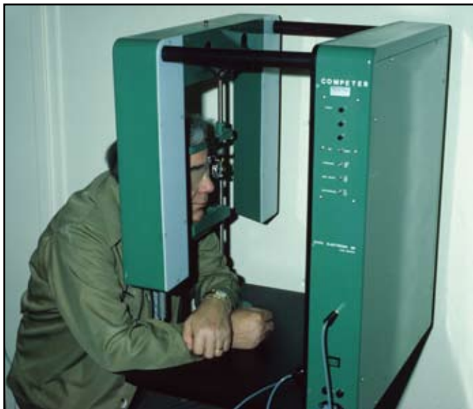
En Competer® från 1980-talet, en tidig kommersiell version av den datorperimeter som Krakau och Heijl utvecklade.
